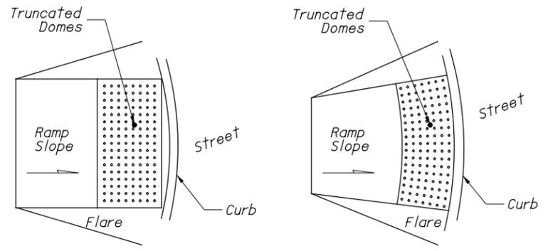
DOME ALIGNMENT ON RADIUSSED CURB
